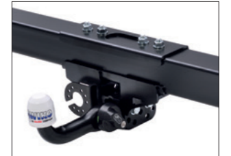
Anhängerkupplung (zulässige Anhängelast max. 2.000 kg gebremst)
