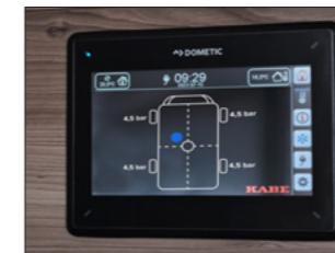
KABE Smart Level. KABE Smart Level wird im Smart D Bedienpanel angezeigt und enthält drei praktische Funktionen. Smart Level überwacht den Gasfüllstand (nur erhältlich für eine Gasflasche, keine Kunststoff-Gasflasche), den Reifendruck und die Neigung des Wohnmobils (Serienmäßig im Imperial).
