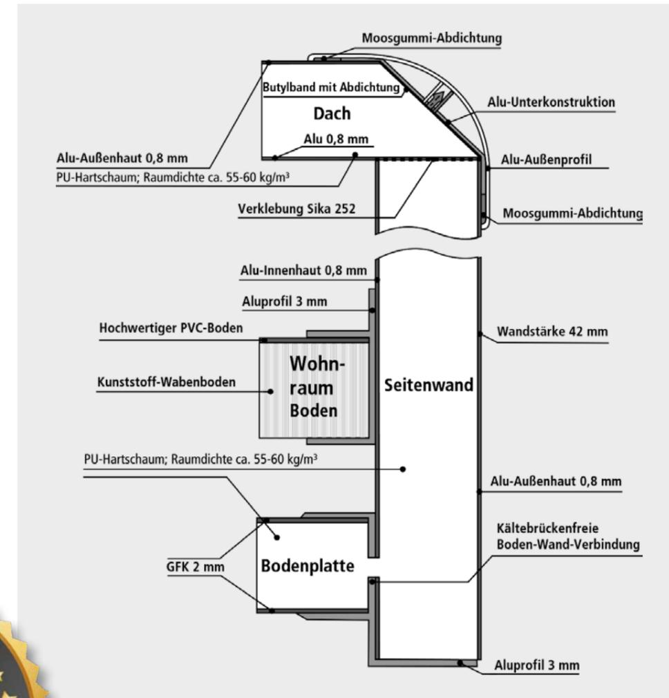
**Bauweise von außen nach innen, erst die Kabine, dann der Innenausbau**
